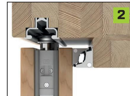
**FLÄCHENBÜNDIGE FÜHRUNGS-SCHIENE MIT ROLLENFÜHRUNG**
